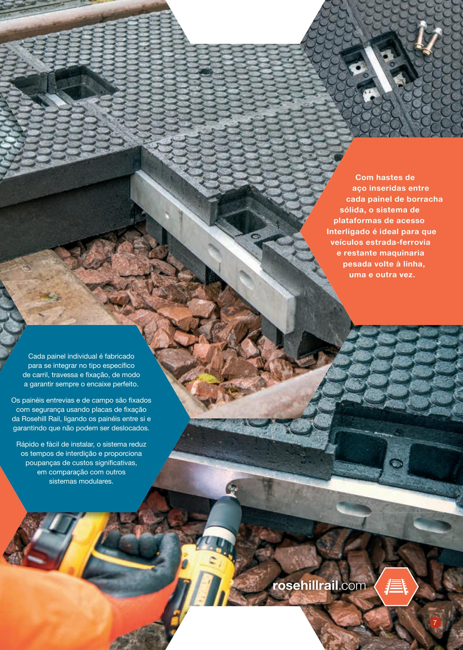
Com hastes de aço inseridas entre cada painel de borracha sólida, o sistema de plataformas de acesso Interligado é ideal para que veículos estrada-ferrovia e restante maquinaria pesada volte à linha, uma e outra vez.
